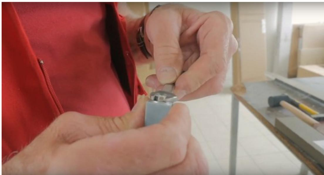
Positionner les rails au dessous du plancher et vissez-les au plancher de l'armoire (vous
