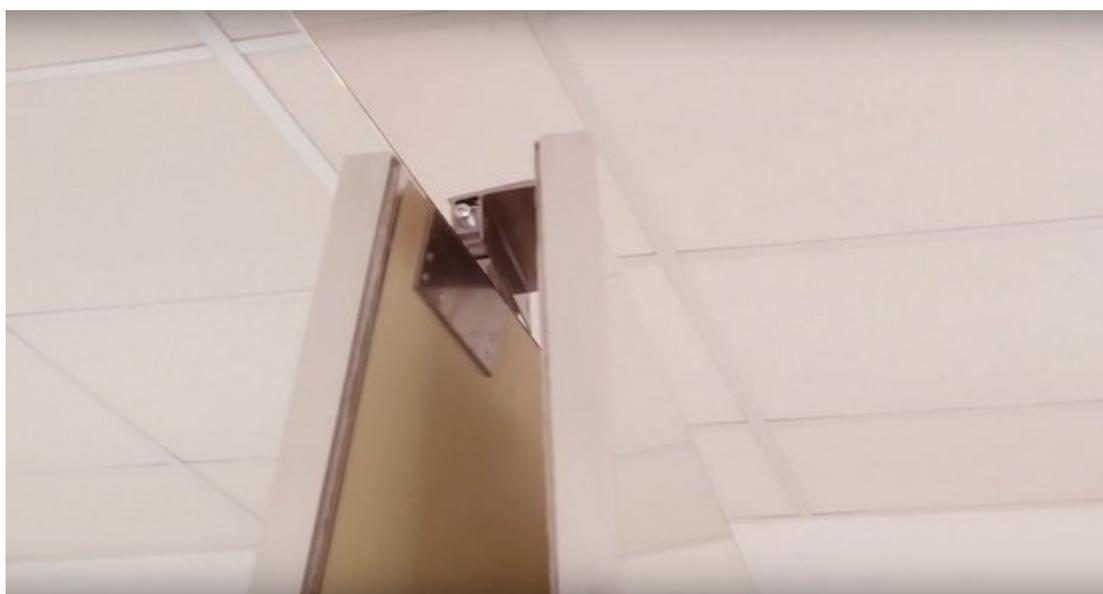
Vérifiez que les portes sont droites. Si la façade penche vers l'intérieur de l'armoire, tirez un peu plus sur le tirant; si la façade penche vers l'extérieur, desserrez légèrement le tirant.
