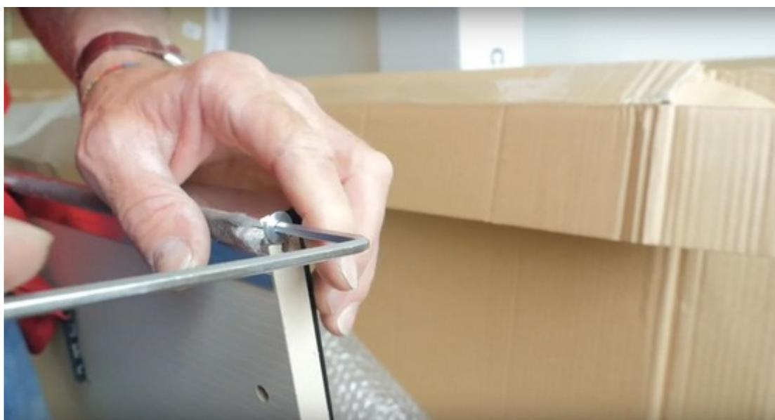
Serrez légèrement les vis positionnées sur le mécanisme supérieur comme indiqué sur la [vidéo](#). Positionnez ensuite le mécanisme supérieur au ras du bord supérieur de la porte (côté intérieur) et fixez-le avec des vis. Deux mécanismes doivent être fixés pour chaque porte.
