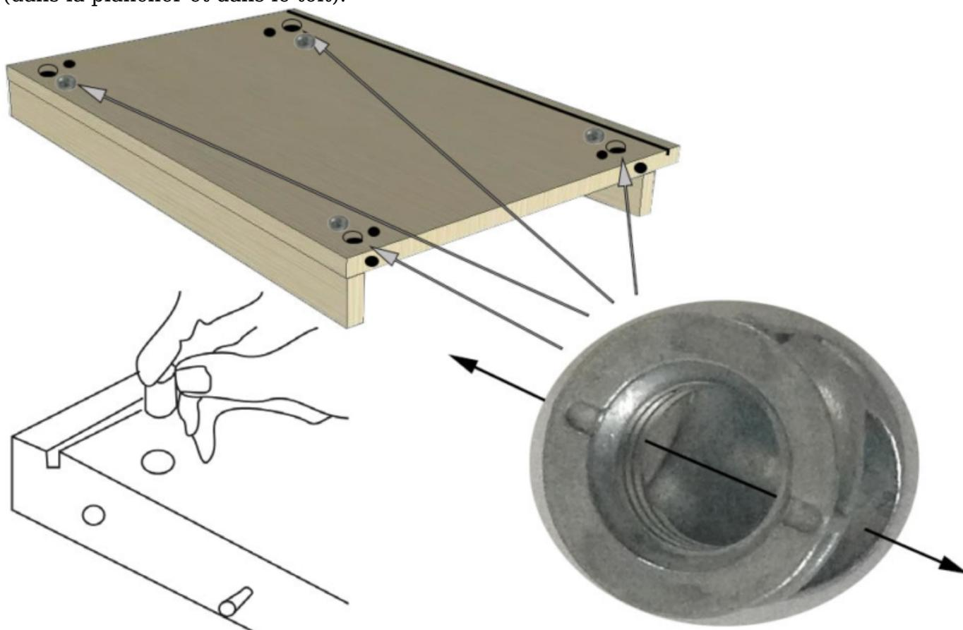
Positionner les deux plancher au sol en les espaçant légèrement pour pouvoir procéder au montage de la joue de séparation. Joignez les plancher à la joue de séparation: insérez d'abord un plancher à la joue et serrez les vis comme illustré ci-dessous; répéter la même opération également avec l'autre plancher de l'autre côté de la joue.
